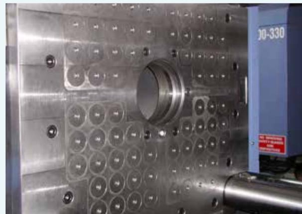
Pressmag SP auf ein 3000 kN (300 t) Maschine
