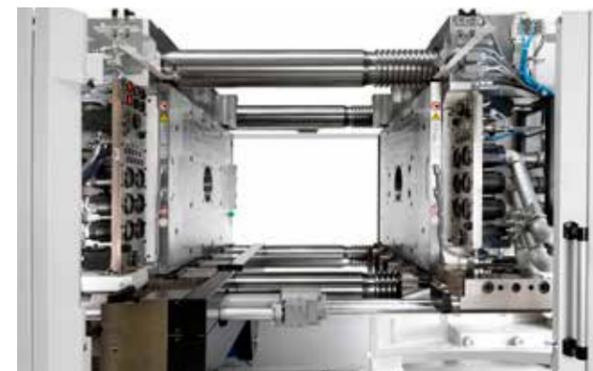
Pressmag LP auf einer 9000 kN Maschine
