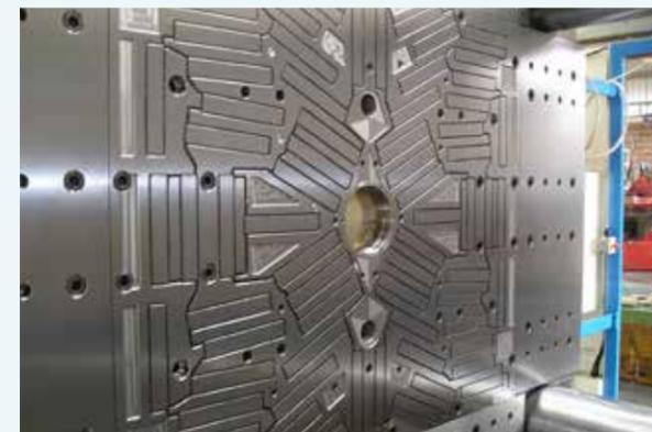
Pressmag HP auf einer 32000 kN Maschine
