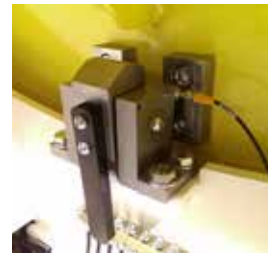
3 positions de verrouillage (0 ° -45 ° -90 °) avec surveillance
